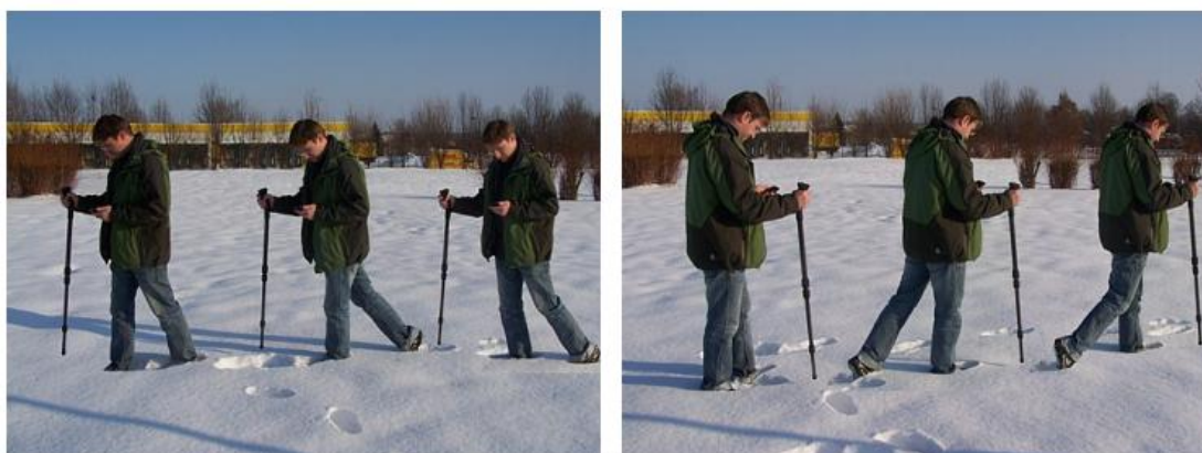
图 7.6. 三维地面扫描操作模式 Z 字形扫描
