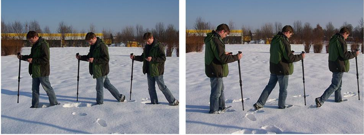
Şekil 6.6: “3D Zemin Tarama” modunda “Zik-zak” tarama
