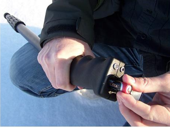
Şekil 5.1: Bataryaları teleskopik antenin içine yerleştiriniz.
