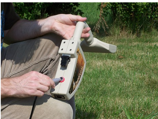
Abbildung 6.3: Power Pack zur Stromversorgung anschliessen
