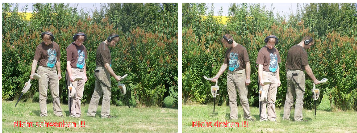
Abbildung 7.3: Das Schwenken und Drehen der Sonde verfälscht die Messungen
