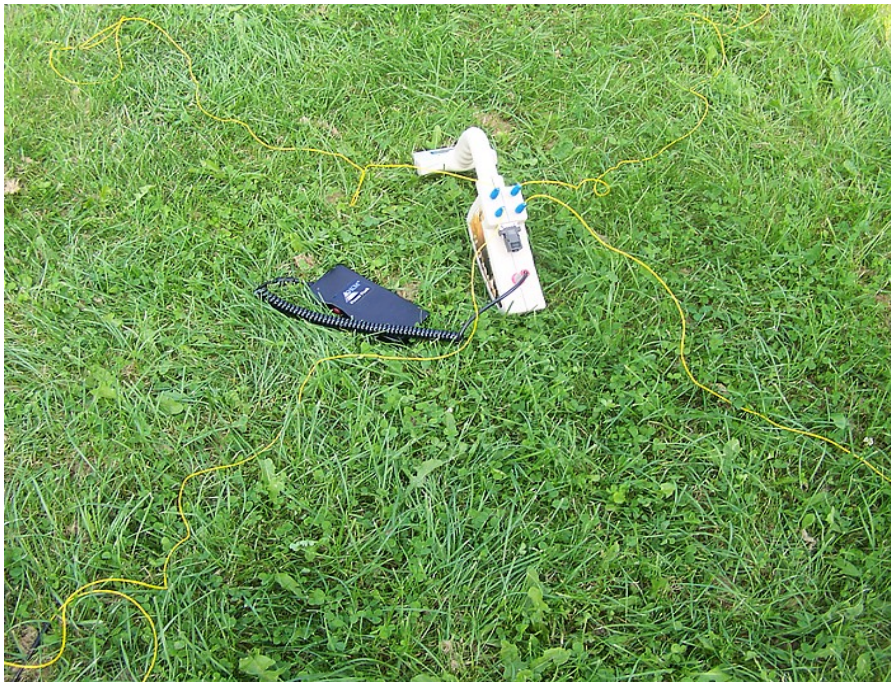
Abbildung 7.6: Anschluss der Elektroden
