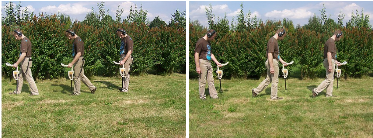
Abbildung 7.5: "Zig-Zag" Messung im Ground Scan
