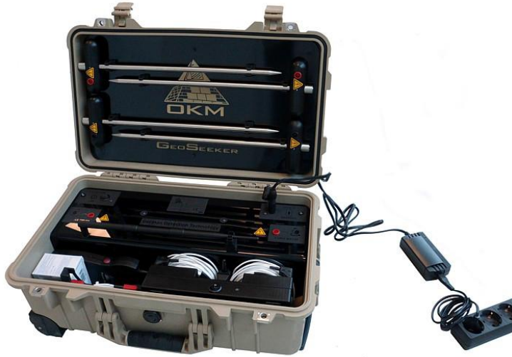
رسم رقم 6.5 : توصيل شاحن علبة الطاقة
