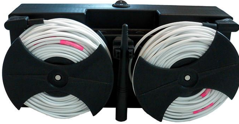
رسم رقم 6.4 : أسطوانات أسلاك الجهد الكهربائي مركبة على الموجه
