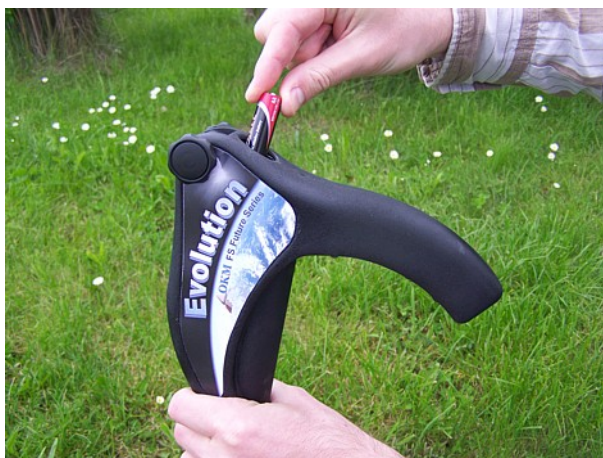
Abbildung 6.3: Batterien in die Teleskopsonde einlegen
