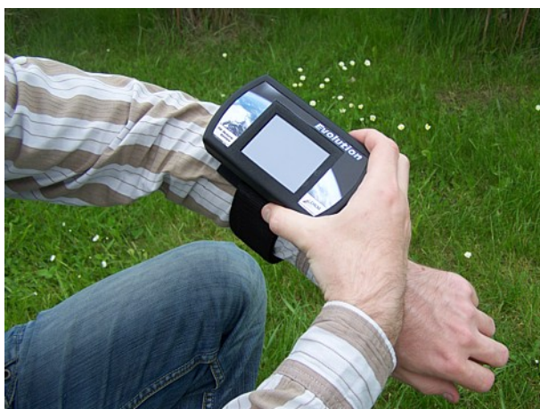
Abbildung 6.9: Kontrolleinheit an der Armbefestigung arretieren (b)
