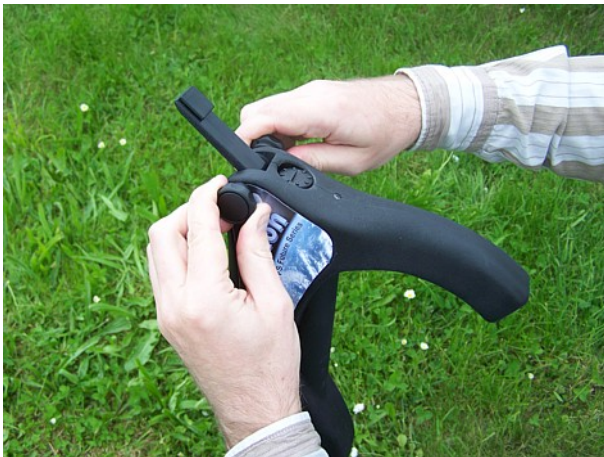
Abbildung 6.6: Kontrolleinheit an der Sonde befestigen (a)
