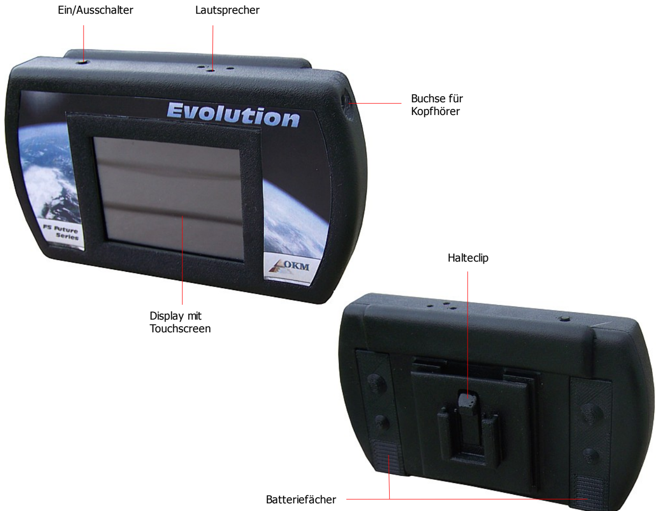
Abbildung 5.1: Übersicht der Bedienelemente der Kontrolleinheit
