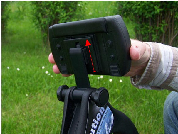
Abbildung 6.7: Kontrolleinheit an der Sonde befestigen (b)
