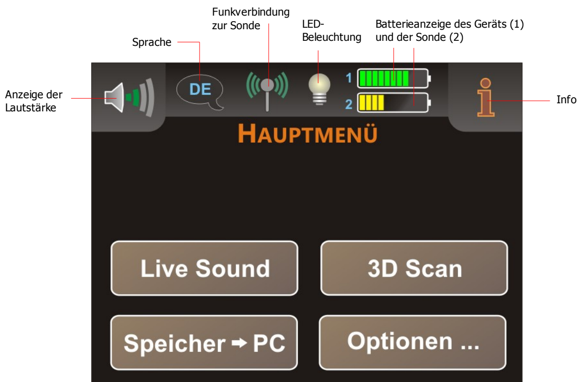
Abbildung 7.2: Hauptmenü der Kontrolleinheit
