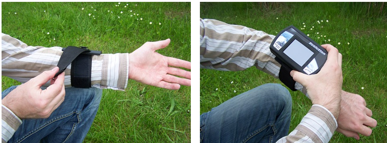
Abbildung 5.4: Befestigung der Kontrolleinheit am Arm
