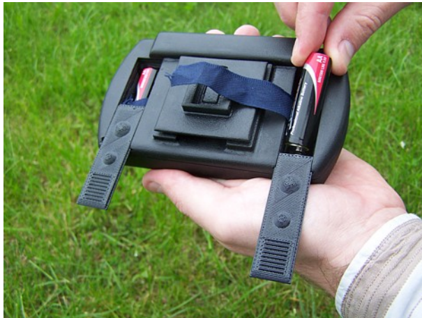
Abbildung 6.1: Batterien in die Kontrolleinheit einlegen
